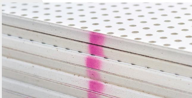
**2** Lorsqu'il est nécessaire de respecter un sens de pose, les plaques sont marquées par un trait rose (les marques ne doivent pas être en vis-à-vis).
