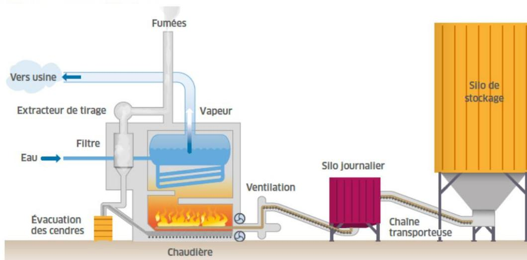
Illustrant, l'engagement de SINIAT en faveur du développement durable, cette chaufferie industrielle permet de couvrir plus de 80% des besoins en vapeur du site et d'éviter 3000 tonnes rejet de CO<sub>2</sub> dans l'atmosphère par an (source : *communiqué de presse Siniat – Engie Cofely du 29 juin 2016*).
