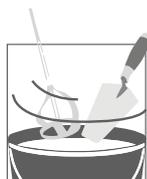
> Gâchage manuel ou mécanique jusqu'à l'obtention d'une pâte homogène
