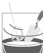
> Gâchage manuel ou mécanique après quelques minutes jusqu'à l'obtention d'une pâte lisse sans grumeaux
