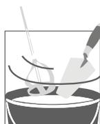
> Gâchage manuel ou mécanique après quelques minutes jusqu'à l'obtention d'une pâte lisse sans grumeaux. Ne pas rebattre après début de durcissement.
