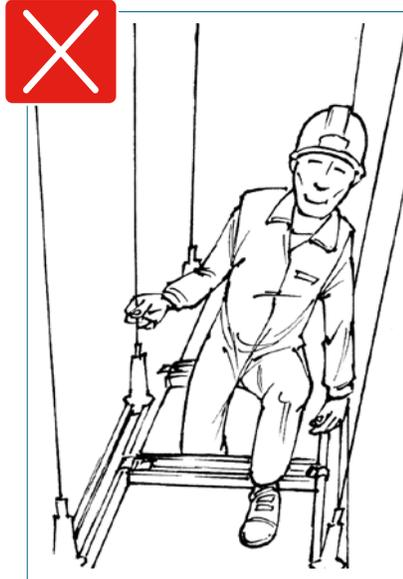
▶ Les conduits de ventilation doivent être fixés au gros œuvre ou à la charpente et ne doivent pas être supportés par l'ossature du plafond.
