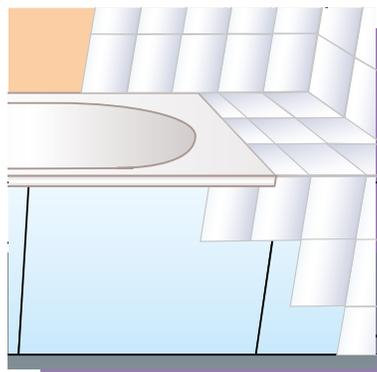
La colle PF3 s'utilise aussi pour enduire et lisser la cloison en carreaux de plâtre PF3 et pour reboucher des trous éventuels. Le carreau PF3 version hydrofugée est également très pratique pour l'habillage de baignoires, parois de douches, la réalisation de jambages dans les salles de bain ou cuisines.
