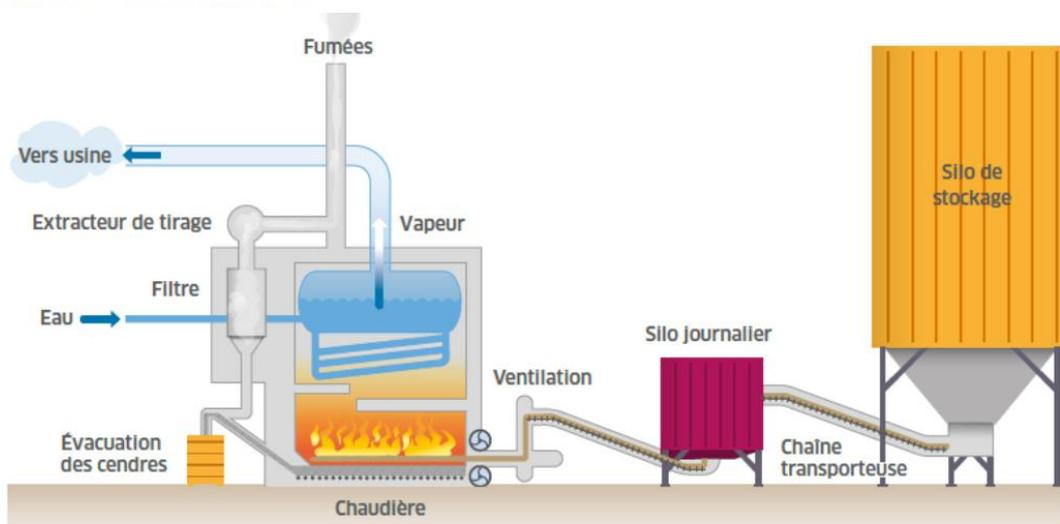
Illustrant, l'engagement de SINIAT en faveur du développement durable, cette chaufferie industrielle permet de couvrir plus de 80% des besoins en vapeur du site et d'éviter 3000 tonnes rejet de CO2 dans l'atmosphère par an (source : *communiqué de presse Siniat – Engie Cofely* du 29 juin 2016).
