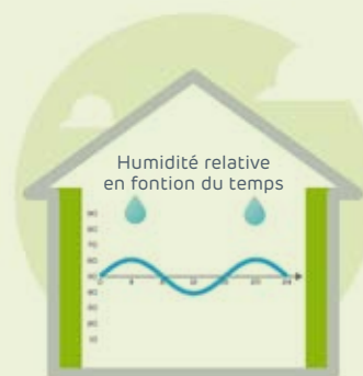
Isolé avec des matériaux hygroscopiques tels que la laine de chanvre
