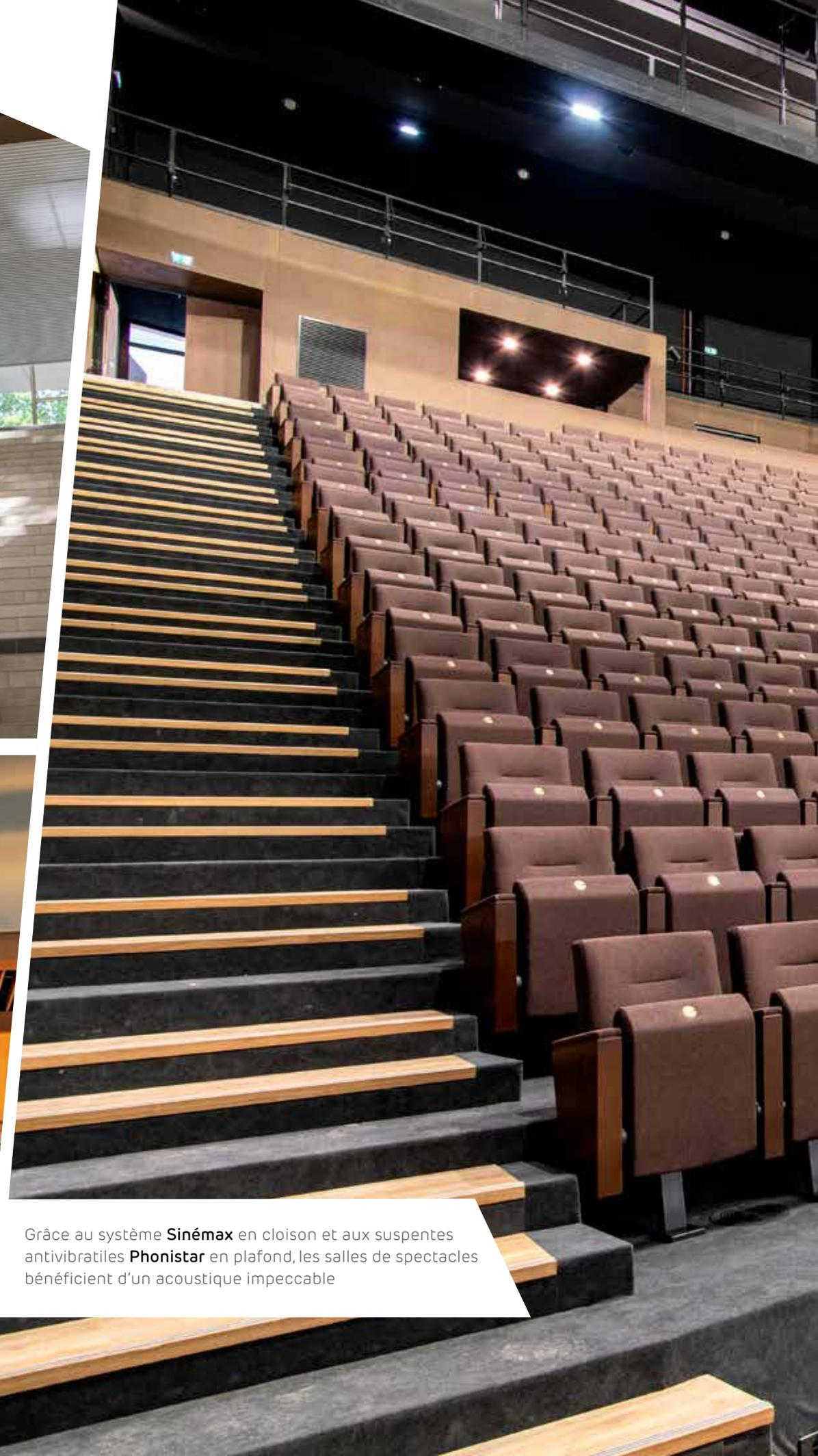
Grâce au système **Sinémamax** en cloison et aux suspentes antivibratiles **Phonistar** en plafond, les salles de spectacles bénéficient d'un acoustique impeccable
