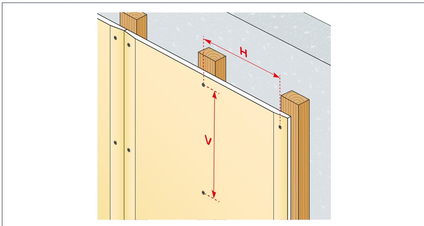
TABLEAU ENTRAXE DES OSSATURES (EN M) ET ENTRAXE DE FIXATIONS DE LA PLAQUE (EN CM)
