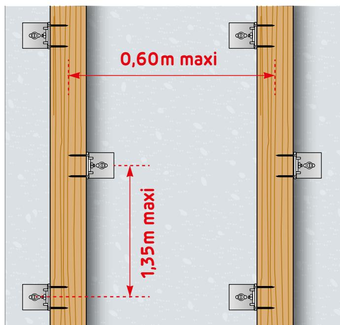
Les équerres sont fixées alternativement de chaque côté de l'ossature, et chevillées au mur support.
