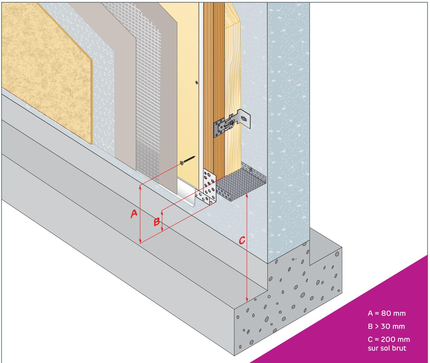
**En partie basse**, le rail de départ AQUABOARD en aluminium perforé doit être fixé sur les chevrons avec les vis PRÉGYWAB 500h et doit dépasser de 30 mm du bas des chevrons (B).
